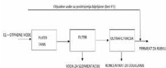
Slika 13.: Ultrafiltracija E-otpadnih voda
