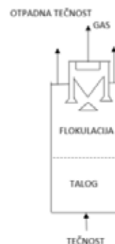
Slika 5. Shema izvedbe prekotočnog anaerobnog postupka.
