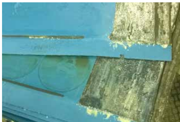
Slika 2. Neadekvatna štamparska forma za lakiranje vododisperzivnim lakom pomoću anilox valjka
