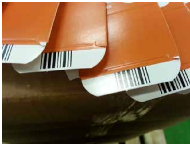
Slika 9. Listanje kartona na mjestu reza na poziciji predviđenoj za zaključavanje poklopca
