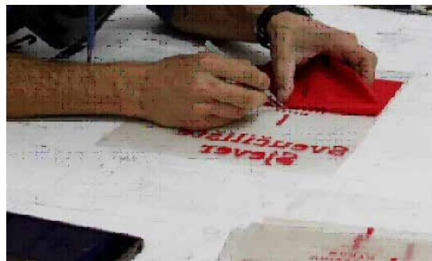
Slika 21. Čišćenje grafike od viška materijala
