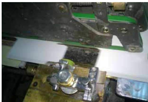
Slika 10. Jedinica za nanos ljepila (disk) na ljepilici
