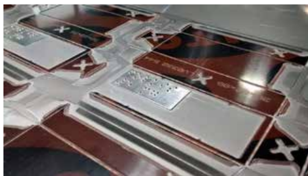
Slika 8. Čelična patrica zalijepljena na kontra formu zajedno sa pertinaxom
