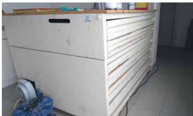
Slika 8. Sušenje emulzije i sita
