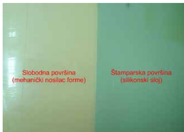
Slika 3. Originalna štamparska forma za lakiranje vododisperzivnim lakom pomoću anilox valjka
