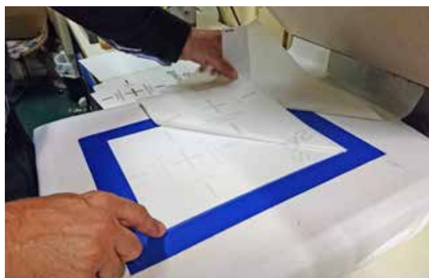
Slika 15. Prva termička obrada, prijenos ljepila sa B papira na A papir
