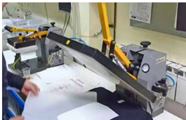
Slika 16. Tisak na majicu, druga termička obrada
