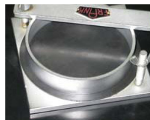
Slika 6. Aparat za ispitivanje površinske upojnosti metodom Cobb
