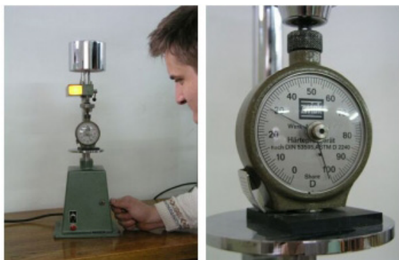
Slika 8. Tvrdomjer za elastomere
