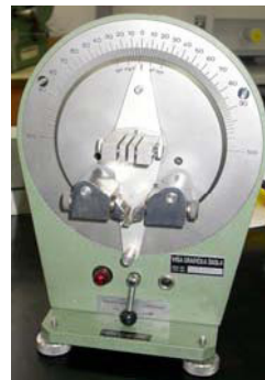
Slika 5. Aparat za određivanje krutosti prema Taberu
