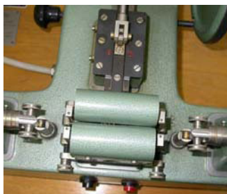
Slika 4. Detalj fiksiranja epruvete na aparatu za određivanje dvostrukih savijanja
