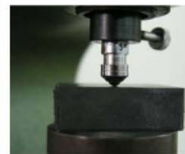
Slika 7. Tvrdomjer s kuglicom za plastomere i duromere
