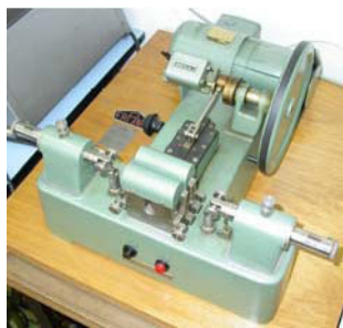
Slika 3. Aparat za određivanje broja dvostrukih savijanja
