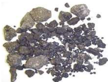
Slika 1. Reciklirani asfalt nakon struganja kao agregatna zrna
