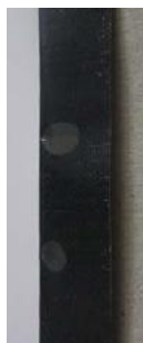
Slika 6. Folija za plastificiranje nije dobro zalijepljena na podlogu
