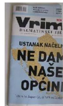
Slika 4. Loše obrezana knjiga. To se događa kada se knjige šivene žicom ili časopisi obrezuju na brzorezačima. Suvremeni trorezači ne rade takve greške.
